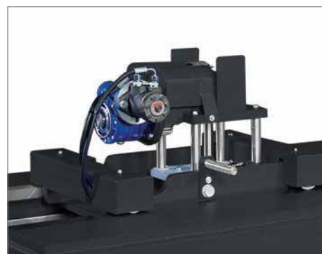
CARRELLO MOBILE CON MOTORE IDRAULICO PER ROTAZIONE TUBO.
