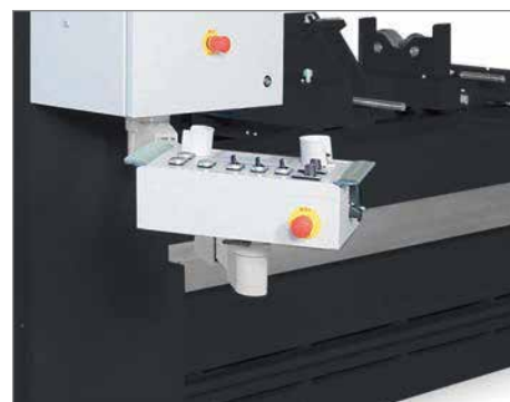
PANNELLO COMANDI CON DISPLAY SIEMENS
