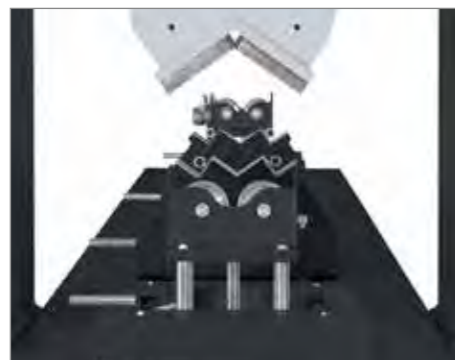
CARRELLI MOBILI CON CILINDRI OLEODINAMICI PER SOLLEVAMENTO TUBO.
